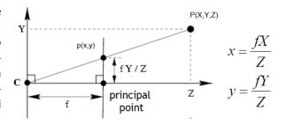
Se abbiamo un punto P nello spazio 3D, questo punto è proiettato nel piano virtuale nel punto p. Notiamo che P rappresenta tutti i punti sulla retta che passa per O e per P (stiamo appunto parlando del piano di proiezione). Il rapporto fra P e p possiamo farlo con la similarità: y: f = Y: Z.
