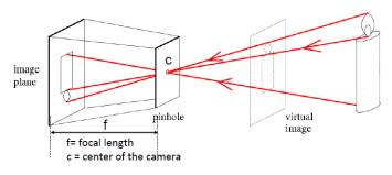
e risultano ribaltati nel piano dell'immagine. La distanza fra il piano dell'immagine e il pinhole si chiama distanza focale. Noi non considereremo l'image plane, ma il **virtual image**, che è esattamente uguale, ma ribaltato (ovvero dritto, non capovolto).
